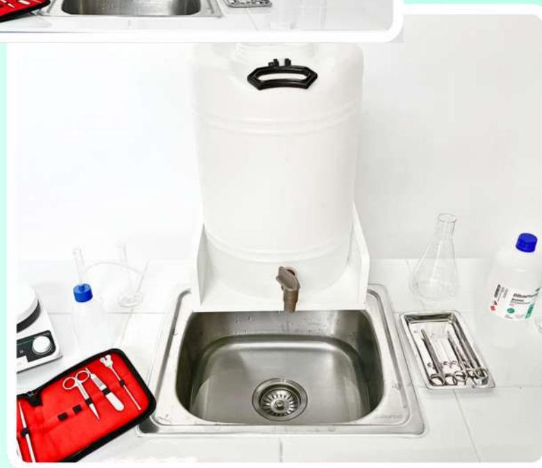
El lavatorio móvil se construye con materiales robustos y de calidad y es trabajado a detalle, además de ser personalizable según el requerimiento del cliente. Incluye dos estanques de 20 litros, con manillas para fácil manipulación. El primer estanque provee de agua al usuario y el segundo se utiliza para almacenar la descarga o residuo.
