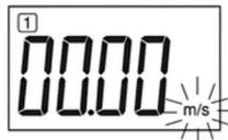
Después de presionar el botón Start, la unidad de medición parpadeará para indicar que está en estado de espera para la medición. La unidad mostrará la velocidad de cualquier objeto que cruce sus dos zonas de sensores. Para medir nuevamente, presione el botón Start para volver al estado de espera.
